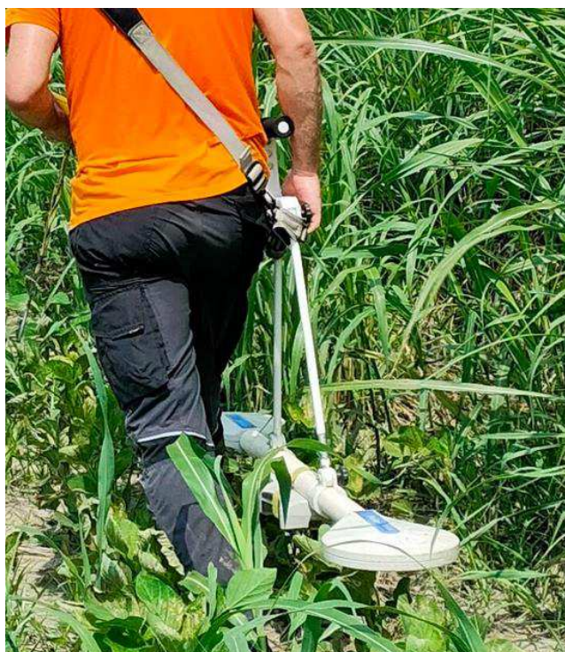
Figura 2 - Elettromagnetometro Profiler EMP-400 (GSSI, USA)
