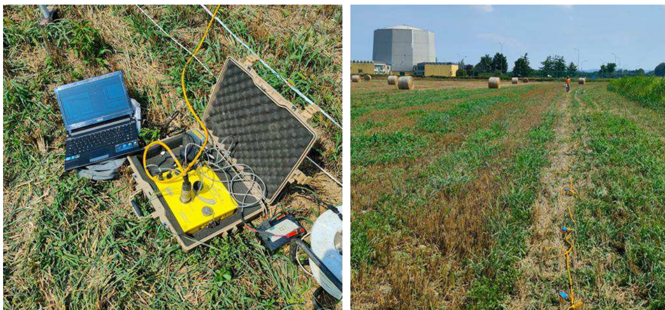
Figura 3 – Sismografo DAQLink IV (Seismic Source, USA)
