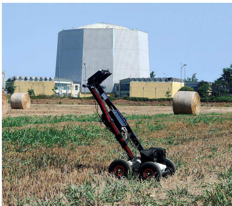
Figura 5 – Strumentazione georadar IDS RIS Hi-Mod (IDS, Italia)
